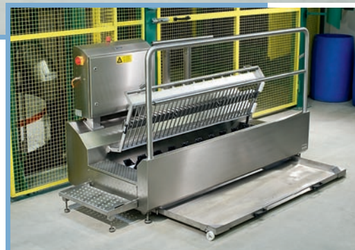
Jednoduché čištění díky nášlapnému roštu, který lze odklopit nahoru, a pojízdné vaně z ušlechtilé oceli
